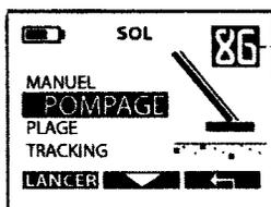
Режимы **Non - motion Audio Disc** (Аудио распознавание в статическом режиме) и **Non - motion All metal** (все металлы) требуют регулировки баланса почвы. Покачайте катушку у земли (см. объяснения на стр.18) и вручную отрегулируйте значение настройки почвы в соответствии со значением, появившемся в правом верхнем углу экрана «Баланс почвы».
