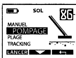
Режимы **Non - motion Audio Disc** (Аудио распознавание в статическом режиме) и **Non - motion All metal** (все металлы) требуют регулировки баланса почвы. Покачайте катушку у земли (см. объяснения на стр.18) и вручную отрегулируйте значение настройки почвы в соответствии со значением, появившимся в правом верхнем углу экрана «Баланс почвы».
