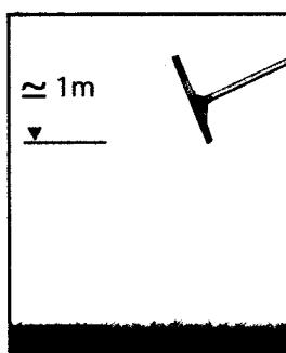
1. Поднимите катушку вверх (на высоту более 1 метра).
