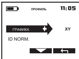
OSCILLOSCOPE DISPLAY XY: Мишень подпись отображается осциллографом. Экран XY обеспечивает визуальную помощь и может улучшить идентификацию сложных целей.
