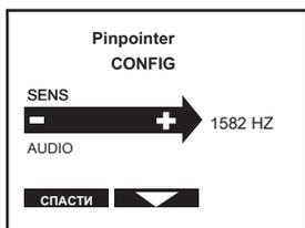
Звуковой сигнал PULSE МИ-6 можно регулировать с пульта дистанционного управления, тона в диапазоне от 120 до
