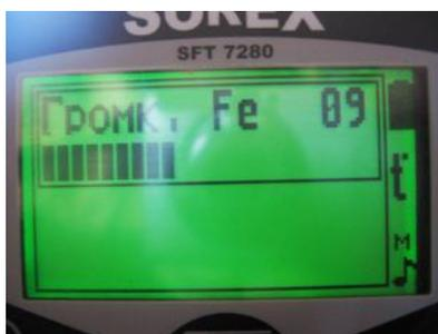
**Тип видео индикации.** Данная опция позволяет переключаться между типами основного рабочего экрана.
