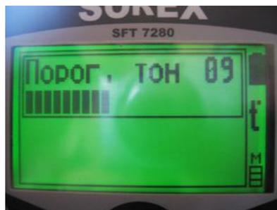
Чувствительность порогового тона на максимальных значениях, больше, чем способность прибора определить металл цели. Поэтому его можно использовать для поиска металлических предметов на глубинах, недоступных для идентификации, когда важно определять наличие любых предметов из металла.
